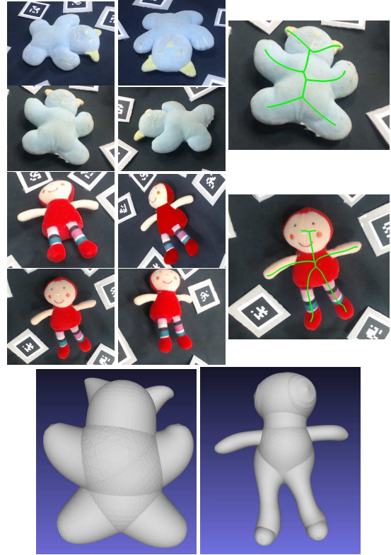
Figure 9: Reconstruction de deux peluches en utilisant notre méthode. 4 images acquises sont présentées pour chaque peluche. À droite, le squelette 3D est projeté sur l'une des images. En bas, les reconstructions sont obtenues pour chaque peluche.
